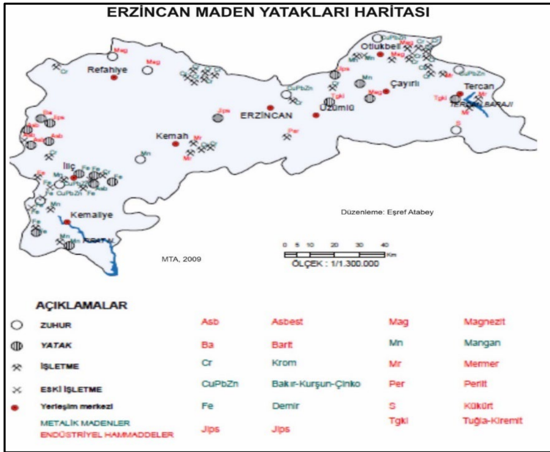
Harita 8: Erzincan ili maden yatakları haritası ve açıklamaları (MTA, 2009'dan düzenleme: Eşref Atabey).
